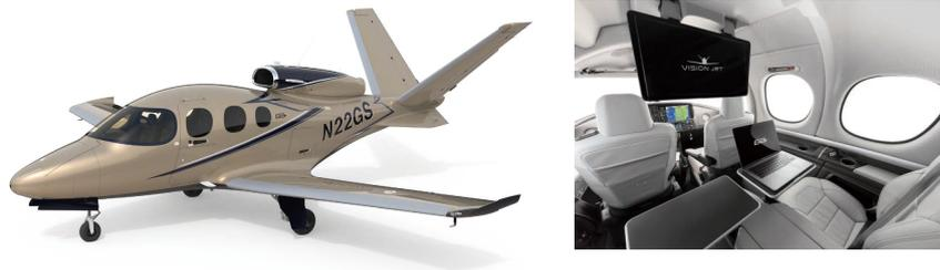
願景噴氣機採用碳纖維科技，提供先進的碳單體殼機身。根據弗若斯特沙利文的資料，採用碳纖維材料帶來諸多競爭優勢，如機身表面更光滑、美觀性、貼合度和光潔度得到改善、繼續降低生產週期時間、提高首次生產質量及通過改善空氣動力學阻力來提高燃油效率並降低碳排放。「背負式」引擎佈局(考慮到飛機的單渦輪特性，引擎置於飛機的頂部而非側面)及V型尾翼設計可降低機艙噪音。安全始終是我們設計的重心。願景噴氣機配備西銳整機降落傘系統及安全返回系統(作為標配功能)。
