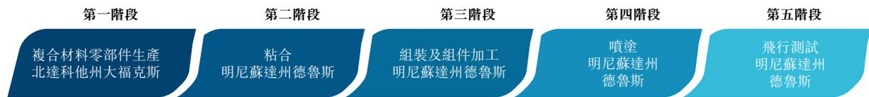
**第一階段：** 複合材料—我們的兩種主要複合材料(即預浸漬玻璃纖維及碳纖維)大部分採購自美國的一家供應商。根據弗若斯特沙利文的資料，複合材料具有耐腐蝕性，可用於製造輕質空氣動力學機身，並令我們取得競爭優勢。我們自主生產所有複合模具。
